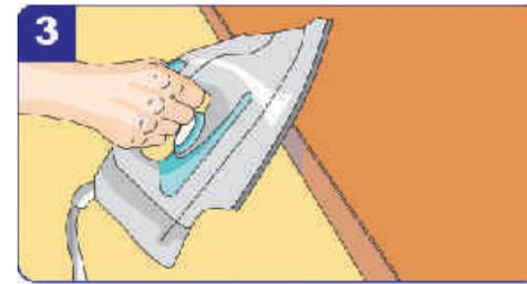
3 Der Umleimer wird mit einem Bügeleisen auf die offene Stirnseite aufgebügelt oder alternativ mit extra dafür vorgesehenem Kleber verklebt. Die Fronten der Arbeitsplatte mit individuell gewähltem Umleimer beschichten.
