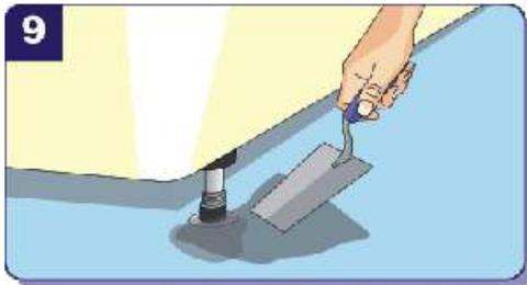
**9** Füße mit Fertigmörtel auf dem Boden fixieren.
