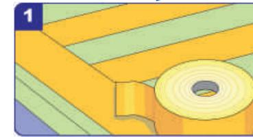
1 Eine schon vorlackierte Fläche wird mit Kreppband so abgeklebt, dass die zweite Farbe auf die freie Flächen aufgetragen werden kann.
