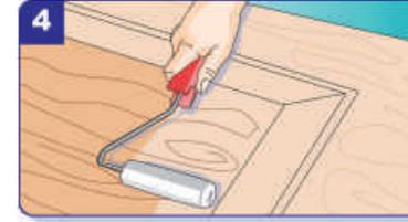
4 Danach alle übrigen Flächen mit einer Lackrolle grundieren, trocknen lassen und die Fläche mit 280er Schleifpapier anschleifen und vom Staub befreien.
