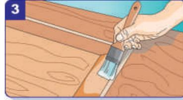
3 Alle Kanten, Ecken und Überstände dünn grundieren und antrocknen lassen.
