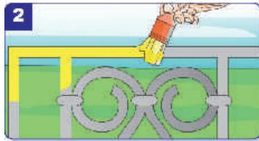
2 Bei neuem Metall die Fläche mit Korrosionsschutz behandeln (Antirostgrundierung). Bei älterem Metall müssen die entrosteten Stellen vor der Grundierung ggf. gespachtelt werden. Nach dem Trocknen die Flächen mit 180er Schleifleinen anschleifen und von Staub befreien.
