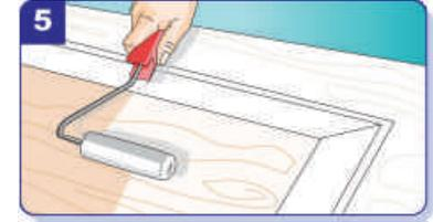
5 Mit Fenster- oder Türenlack wird ein Zwischenanstrich aufgetragen. Ecken etc. werden mit dem Pinsel und die Flächen mit der Lackrolle bearbeitet. Die Lackierung sollte zuerst senkrecht, danach quer und zuletzt wieder senkrecht auf jeder Bahn verlaufen (Kreuzgang). In der Zwischenzeit darf der Lack nicht trocknen.
