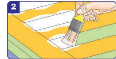
2 Das Kreppband sollte nach dem Anstrich sofort wieder entfernt werden, da ansonsten beim Abziehen bereits ange-trockneter Lack mit abgerissen werden kann.
