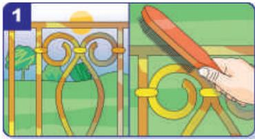
1 Sollten Sie neue Metallflächen lackieren, entfernen Sie vor der Bearbeitung die Fettschicht mit Verdünnung. Altes oder rostiges Metall wird zuerst mit der Drahtbürste und Schleifpapier entrostet. Danach den Staub gründlich entfernen und die Roststellen schnell und gründlich bearbeiten, da diese schnell wieder sichtbar werden.
