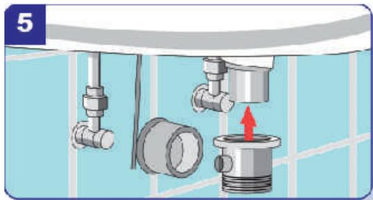
Montage des Ablaufventils: Das Ventiloberteil mit einem Dichtungsring bestücken und von oben in den Ablauf ein-setzen. Das Unterteil an das Oberteil ansetzen und mit-einander verbinden.
