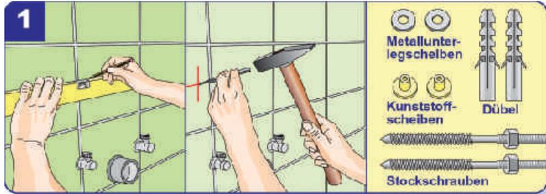
Bohrlöcher mittig über dem Abfluss anzeichnen und mit einem Körner leicht an-körnen, damit der Bohrer beim Bohren nicht abrutscht.
