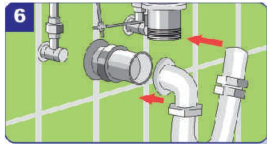
Den Siphon auf das Abflussrohr stecken und mit dem Ablaufventil verbinden. Alle Schrauben noch mal auf Festigkeit prüfen.
