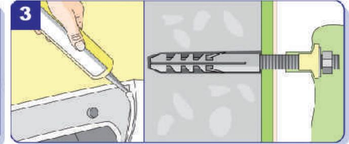
Das Becken sollte auf der Rückseite mit Sanitärsilikon versehen werden um Spannungen zu vermeiden. Das Becken über die Stock-schrauben und danach die Kunststoff-scheiben über die Stock-scheiben schieben, die Metallunter-legscheiben nachlegen und die Mutter ab-wechselnd anziehen um Spannungen zu vermeiden.
