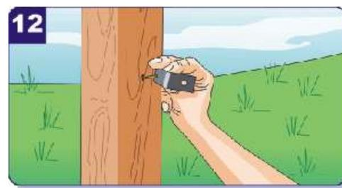
Für die Fixierung der L-Beschläge verwenden Sie Nirosta-Schrauben und ziehen Sie sie mit einem Akku-Schrauber fest.
