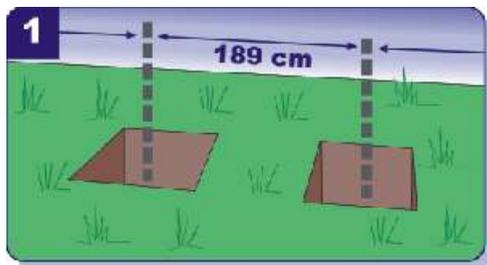
Den genauen Zaunverlauf markieren Sie mit einer Richtschnur und messen die benötigten Abstände (Zaunelemente-Nennmaß 180 cm) zwischen den Zaunpfosten aus!
