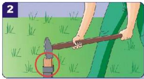
Machen Sie es leicht mit Einschlagbodenhülsen (z.B. 9x9 cm): Loch in den Boden stechen, Hülse aufstellen und mit Hammer und Kantholz einschlagen.
