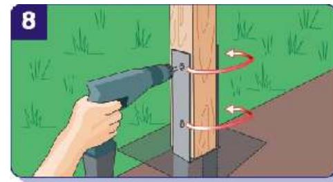
Bei beiden Befestigungsarten gilt: Pfosten einsetzen, ausrichten und anschließend von beiden Seiten durch die oberen Löcher bohren und mit Maschinenschrauben befestigen.
